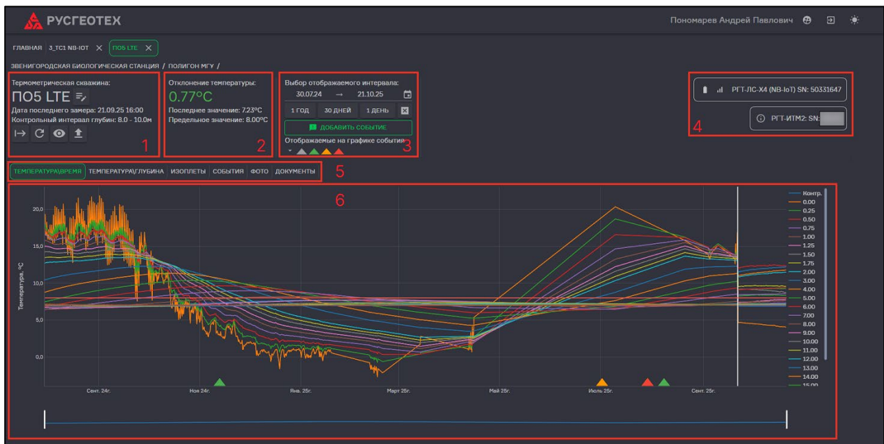
Рисунок 31. Основная страница термометрической скважины: 1 – свойства точки наблюдения; 2 – пороговые значения; 3 – настройка интервалов и событий; 4 – информация об измерительном устройстве, качестве сигнала; 5 – панель страниц точки наблюдения; 6 – поле страницы.
