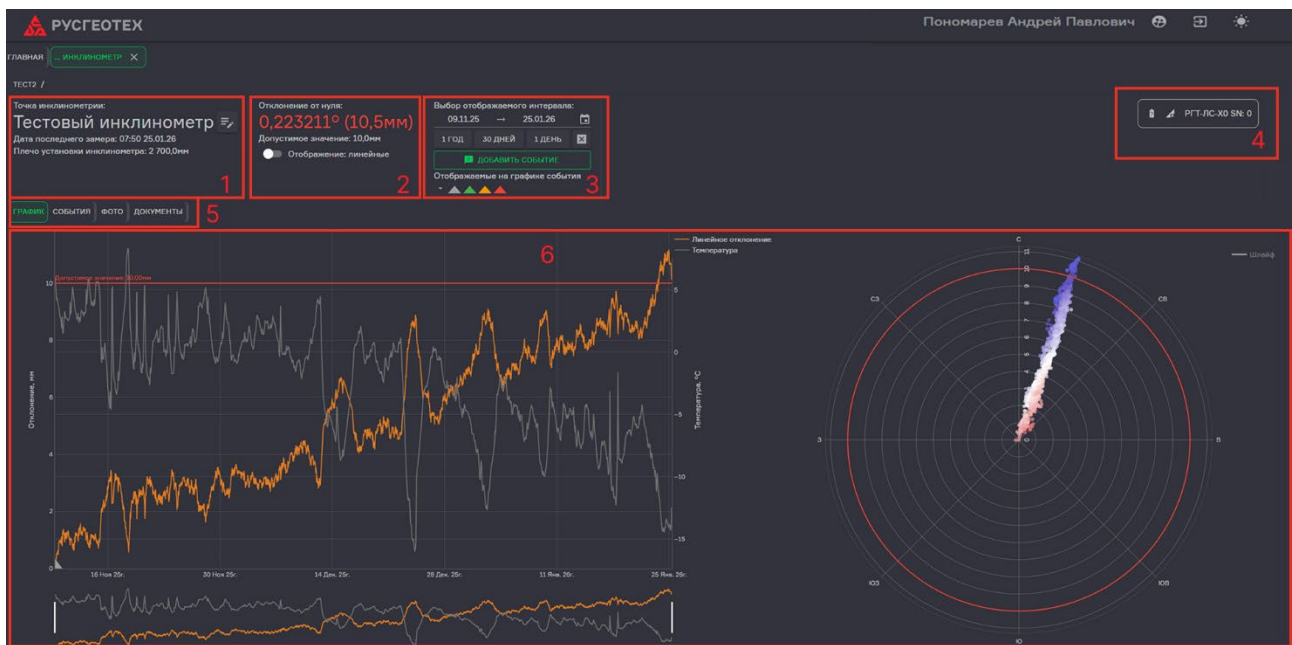
Рисунок 42. Основная страница точки инклинометрии: 1 - свойства точки наблюдения, 2 - пороговые значения, 3 - настройка интервалов и событий, 4 - информация об измерительном устройстве, качестве сигнала, 5 – панель страниц точки наблюдения, 6 – поле страницы.
