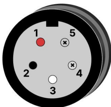
Рисунок 6. Распиновка разъема термокосы: 1 – «+5 В», 2 – «Data», 3 – «-5 В».
