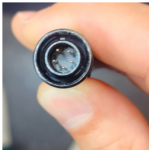
Рисунок 6. Распиновка разъема термокосы: 1 – «+5 В», 2 – «Data», 3 – «-5 В».
