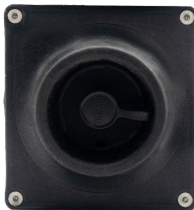
Рисунок 25 Нижняя сторона РГТ-ЛС, разъем ИТМ
